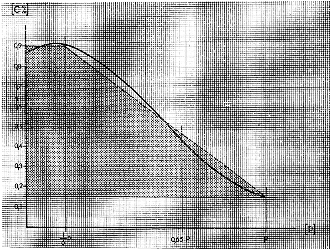
Fig. 6 - Percentuali di Carbonio in un acciaio cementato.
