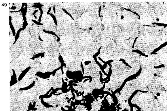
Struttura di ghisa grigia austenitica Ni Resist contenente nichel, rame, cromo e fosforo - Attacco: HCl 10% bollente - X 400.
