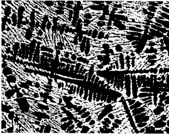
Dendriti di austenite in via di accrescimento. Struttura ottenuta temprando la ghisa da temperatura leggermente superiore alla linea EF (X 200).
