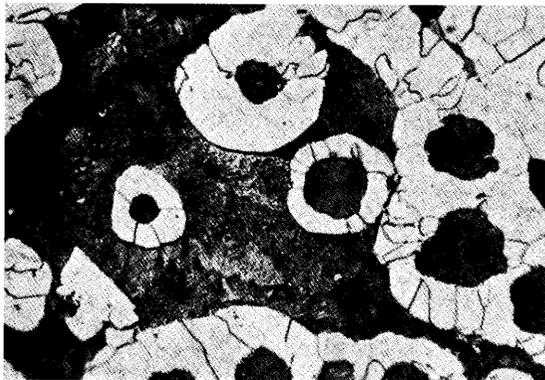
Ghisa sferoidale con matrice ferritico-perlitica - Attacco Nital X 200.
