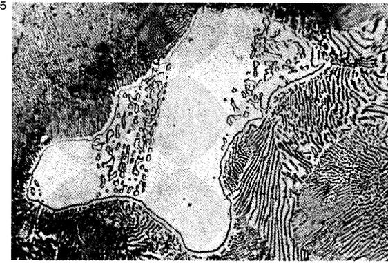
Eutettico fosforoso. Attacco Nital X 1000.
