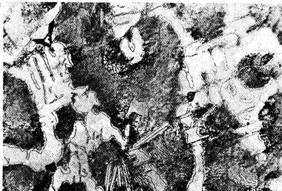
Struttura tipica di ghisa bianca per malleabile (cementite, ledeburite, perlite) - Attacco Nital X 200.
