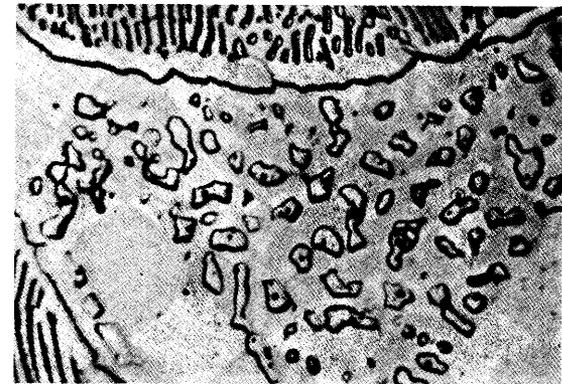
Eutettico fosforoso (steadite) - Attacco Nital - X 400.
