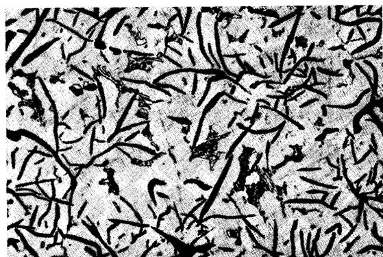
Struttura tipica di ghisa grigia austenitica Ni-Resist - Attacco: HCl 10% bollente - X 100.
