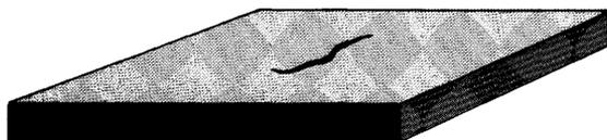
Esempio tipico di rottura dovuto a riscaldamento troppo rapido su di un basamento di ghisa grigia.
