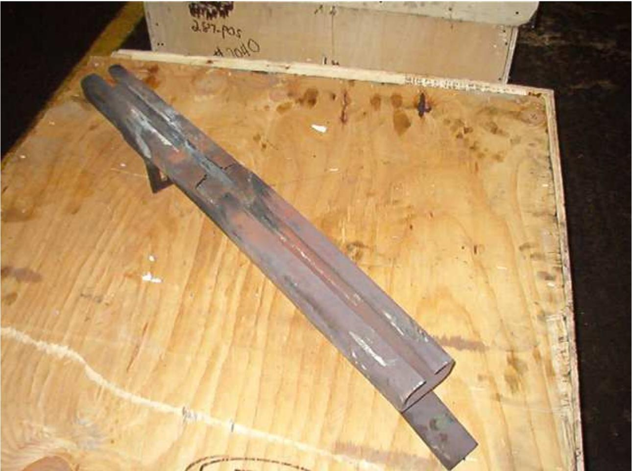
Fig.4 Guida di caricamento in camera calda di un forno sealed quench usato per cementazione carburante.
