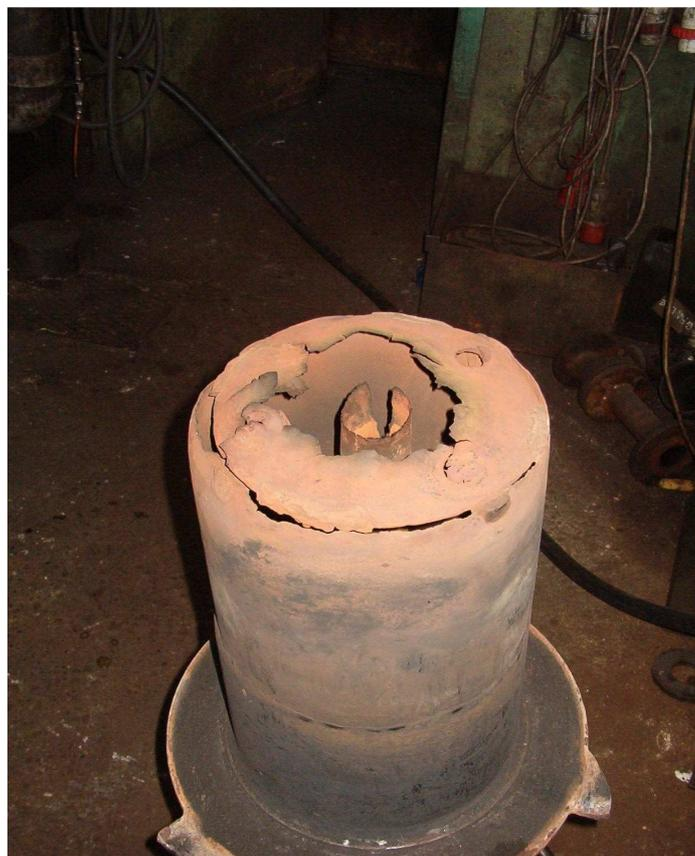
Fig.3 Tappo di una storta rotante da cementazione. Corrosione da “metal dusting” nella zona verso l’interno della storta.
