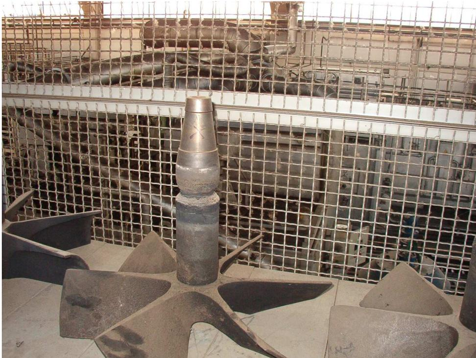
Fig.2 Ventola di agitazione dell'atmosfera della camera calda di un forno sealed quench. Il gambo della ventola è fortemente corrosivo nella zona corrispondente alla temperatura di 700-800°C
