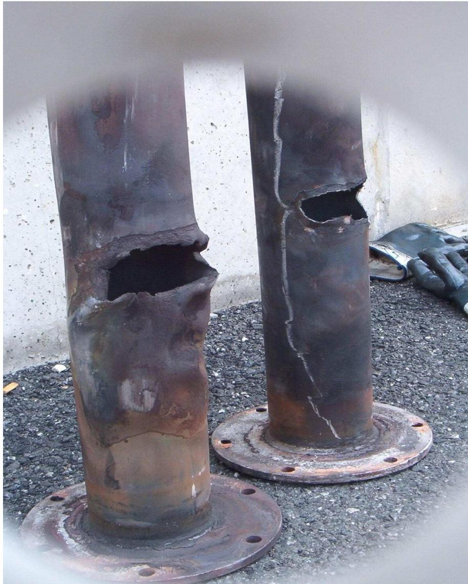
Fig.1 Tubi radianti di riscaldamento a metano di un forno sealed quench. Corrosi dal fenomeno di polverizzazione a temperatura di 700-800°C nella zona di passaggio dalla camera di cementazione alla volta refrattaria del forno.
