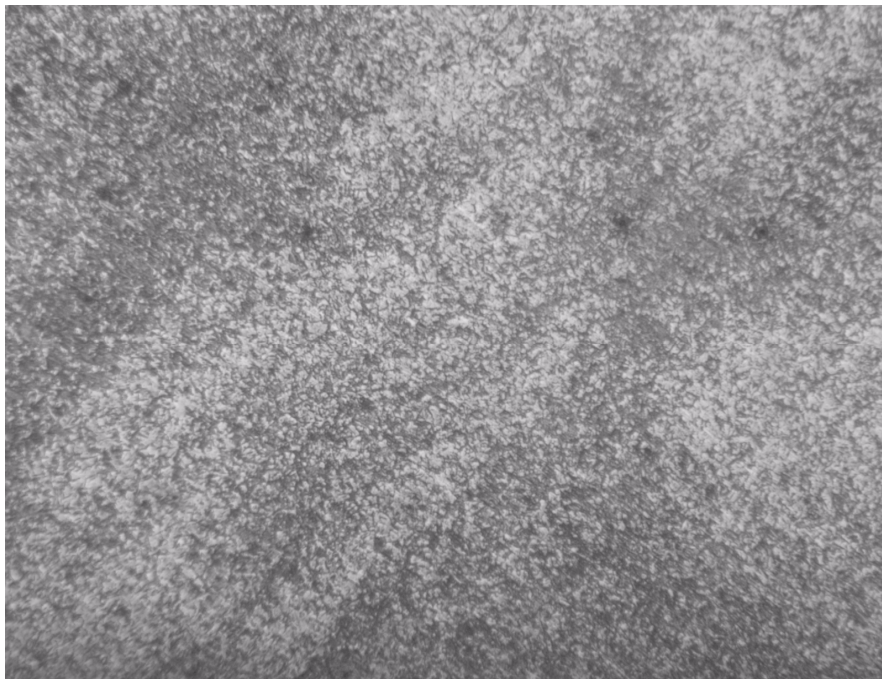
Fig.6 Microstruttura 100X della colata B a tutta tempra.
