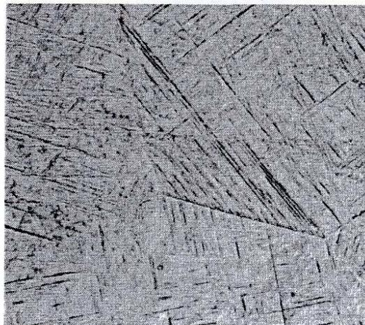
Fig.7 Microstruttura tipica della lega Ti 6Al 4V temprata da una temperatura leggermente al di sopra del beta transus. La struttura è composta per il 100% da beta trasformata.
