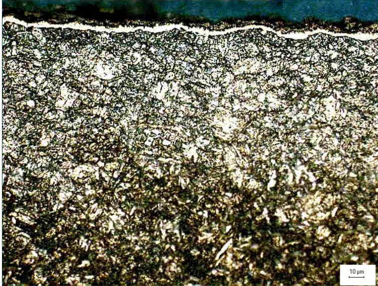
*Figura 4.15 Particolare del Provino 1 attaccato con Nital 4 osservato al microscopio ottico a 500x.*
