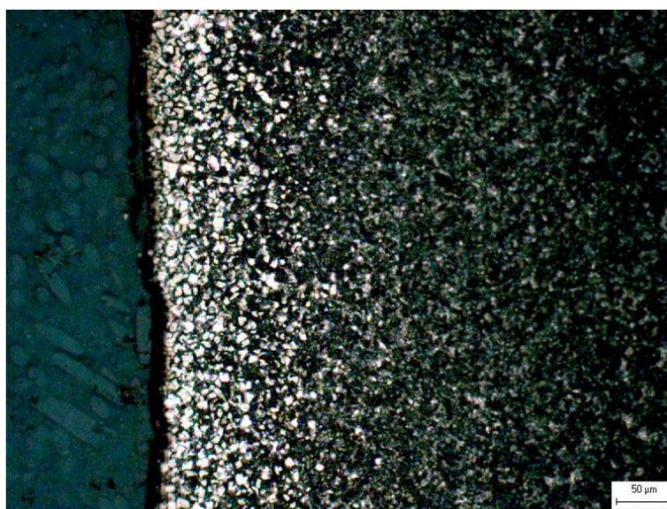
*Figura 4.3 Dettaglio del Provino3, attaccato con Nital 4 e osservato al microscopio ottico (200x).*
