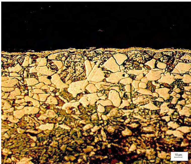
*Figura 4.24 Particolare del Provino 5 attaccato con Nital 4 osservato al microscopio ottico a 500x.*
