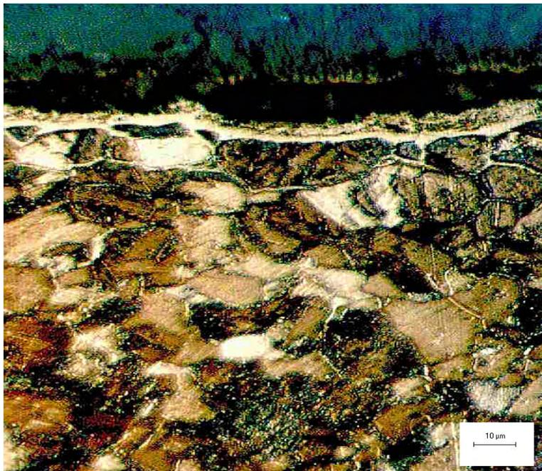
*Figura 4.27 Particolare del Provino 6 attaccato con Nital 4 osservato al microscopio ottico a 1000x.*
