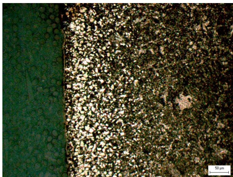
*Figura 4.6 Dettaglio del Provino6, attaccato con Nital 4 e osservato al microscopio ottico (200x).*
