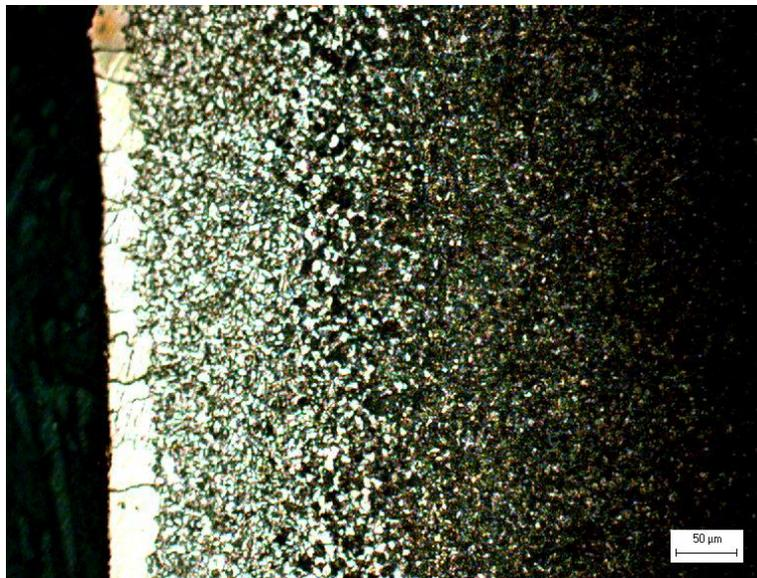
*Figura 4.2 Dettaglio del Provino2, attaccato con Nital 4 e osservato al microscopio ottico (200x).*
