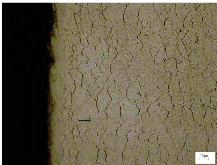
*Figura 4.11 Particolare del Provino 0 attaccato con Murakami osservato al microscopio ottico a 500x.*
