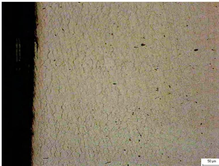
*Figura 4.12 Particolare del Provino 0 attaccato con Murakami osservato al microscopio ottico a 200x.*
