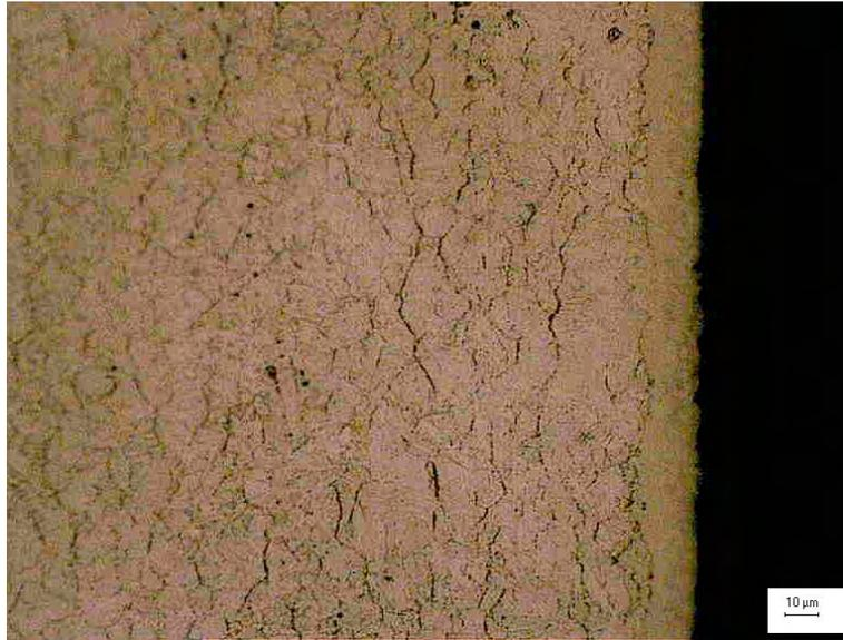
*Figura 4.21 Particolare del Provino 4 attaccato con Murakami osservato al microscopio ottico a 500x.*
