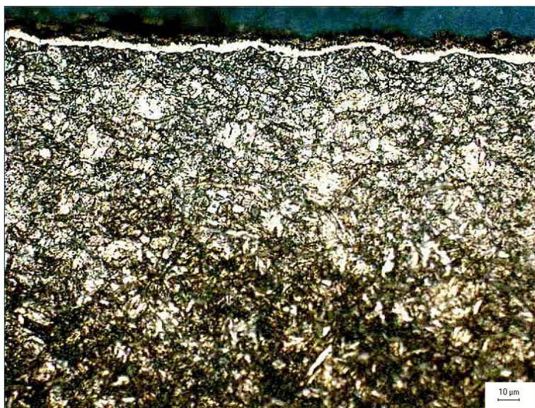
*Figura 4.10 Particolare del Provino 0 attaccato con Nital 4 osservato al microscopio ottico a 500x.*
