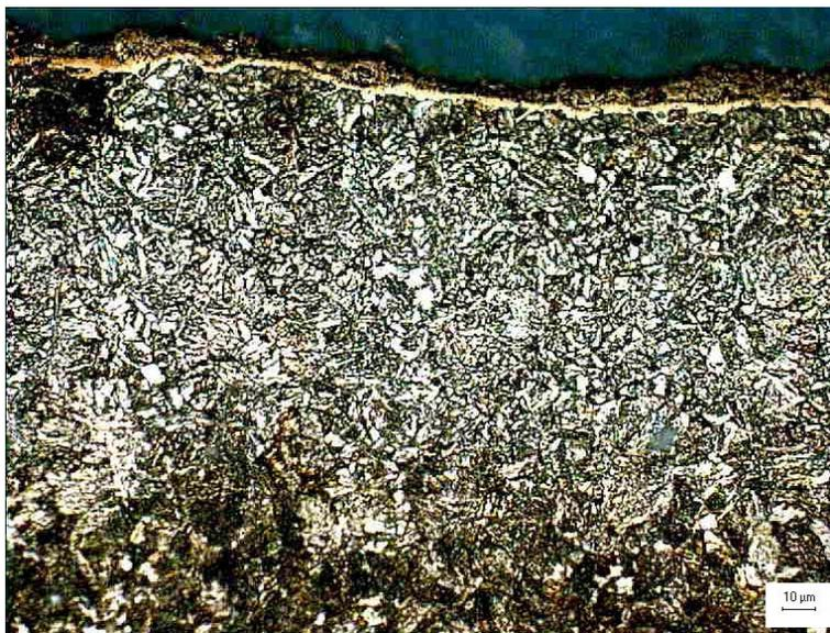
*Figura 4.19 Particolare del Provino 3 attaccato con Nital 4 osservato al microscopio ottico a 500x.*
