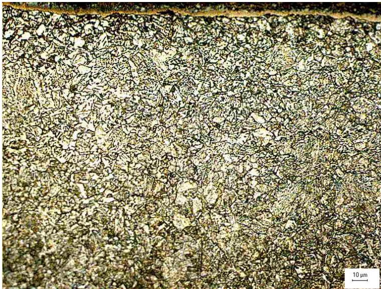
*Figura 4.16 Particolare del Provino 2 attaccato con Nital 4 osservato al microscopio ottico a 500x.*
