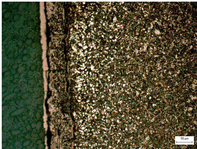
*Figura 4.5 Dettaglio del Provino5, attaccato con Nital 4 e osservato al microscopio ottico (200x).*
